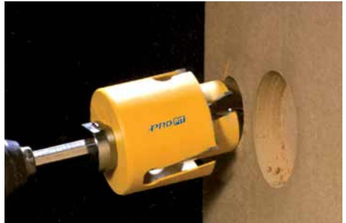
Vergrößerung einer Bohrung
