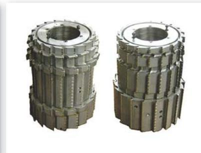
Kombinationsfräser mit Doppelfeder & stufenfalz festbestückt
