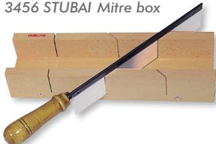
Aus gedämpftem Buchenholz, 15 mm, für Winkel von 45° und 90°, verleimt und verschraubt.
