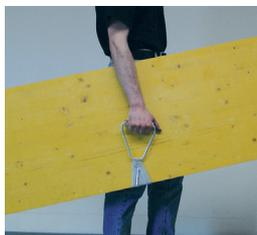
Aus Stahl verzinkt mit Verstärkungsgrille und Holzgriff. Der Plattenheber mit dem eine Person allein schwere oder unhandliche Platten mit einer Stärke von 35 mm heben und tragen kann. Durch die Schwenkplatte können auch Steigungen und Stufen leicht überwunden werden. Max. Tragkraft bis 70,00 kg Max. Breite der Platten: 35 mm.
