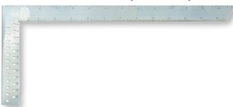
Mit Skala und markierten Anreißblöchern. Aus hochwertigem Federstahl, verzinkt, poliert, gehärtet, hohe Winkelgenauigkeit, Präzisionsschliff, Schenkelbreite 40/50 mm, stumpfgeschweißt. Ermöglicht eine glatte Auflagefläche.
